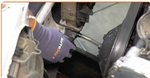
**10** Odpojte hornú hadičku chladiacej kvapaliny.
