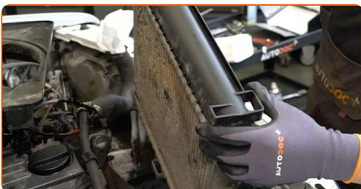
**20** Odstráňte montážne podložky chladiča motora.
