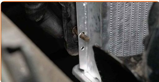
**28** Zaskrutkujte upevňovacie prvky uloženia ventilátora. Použite kombinačný kľúč č.10. Použite nástavec č.10. Použite ráčňový kľúč.
