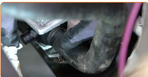
**30** Utiahnite svorku spodnej hadice chladiacej kvapaliny. Použite nástavec č.7. Použite ráčňový kľúč.
