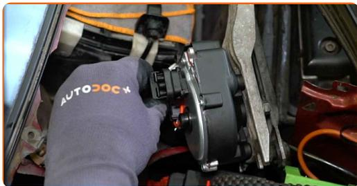
**31** Utiahnite upevňovacie prvky mechanizmu stieračov čelného skla. Použite nástavec č.10. Použite momentový kľúč. Utiahnite ju krútiacim momentom 13 Nm.
