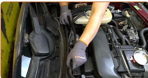
**4** Nainštalujte stredový prvok, ktorý drží tesnenie odvodného kanálika pod stieračmi čelného skla.
