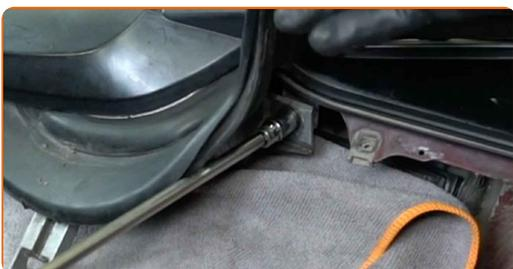
**12** Odpojte konektor elektromotora stieračov.
