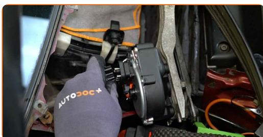
**30** Pripevnite konektor elektromotora stieračov.
