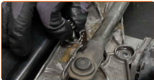
**19** Odpojte mechanizmus spojenia stieračov od hriadeľa elektromotora.
