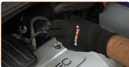
6 Odskrutkujte zátku plniaceho hrdla olejového systému.
