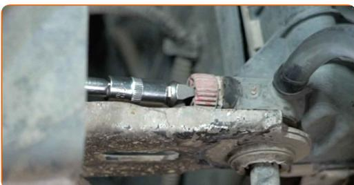
**17** Vypusťte chladiacu kvapalinu z motora.
