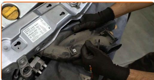
5 Odskrutkujte upevňovací prvok krytu motora. Použite hviezdicový Torx T30. Použite ráčňový kľúč.
