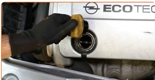
7 Odstráňte uzáver olejového systému.
