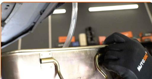
**16** Otvorte výpustný kohútik chladiacej kvapaliny. Použite plochý skrutkovač.
