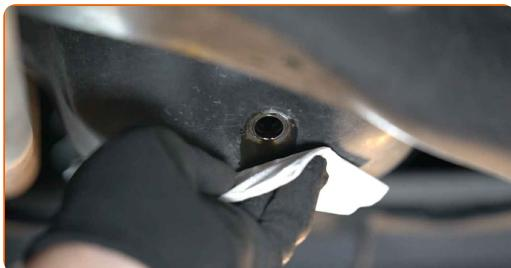
**6** Zaskrutkujte novú zátku výpustného otvoru a utiahnite ju. Použite kombinačný kľúč č.14 Použite momentový kľúč. Utiahnite ju krútiacim momentom 25 Nm.
