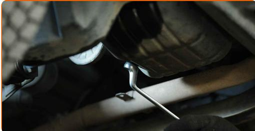
**7** Vyčistite miesto výpustného otvoru olejovej vane. Použite viacúčelový čistiaci sprej.
