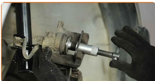
**19.1** Nainštalujte brzdový strmeň a upevnite ho.
