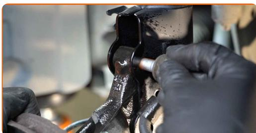
**42** Utiahnite spodné upevňovacie prvky spájajúce vzperu tlmiča k hlave ložiska čapu. Použite kombinačný kľúč č.17. Použite nástavec č.17. Použite momentový kľúč. Utiahnite ju krútiacim momentom 115 Nm.
