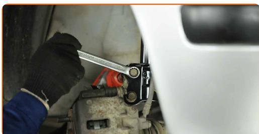
**43** Upevnite brzdovú hadičku na vzperu.
