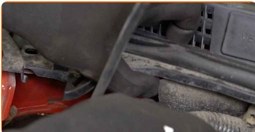
**5** Vyčistite upevňovacie prvky vrchného ložiska vzpery tlmiča. Použite drôtenú kefu. Použite sprej WD-40.
