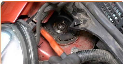
**6** Uvoľnite horné upevňovacie prvky tlmiča. Použite nástavec č.13. Použite ráčňový kľúč.
