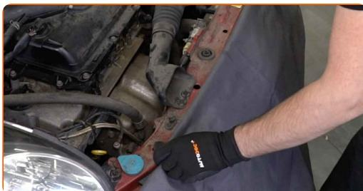
**3** Odskrutkujte upevňovacie prvky plastového krytu pod stierače. Použite nástroj na odstránenie spony. Použite krížový skrutkovač PH.
