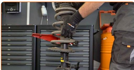
Výmena: jednotka pruženia, tlmič pruženia – VW Multivan T5. Tip od AUTODOC:
