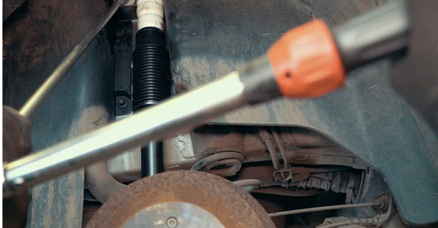
Výmena protiprachovej manžety a dorazu pružiny na vzperu zavesenia kolies
