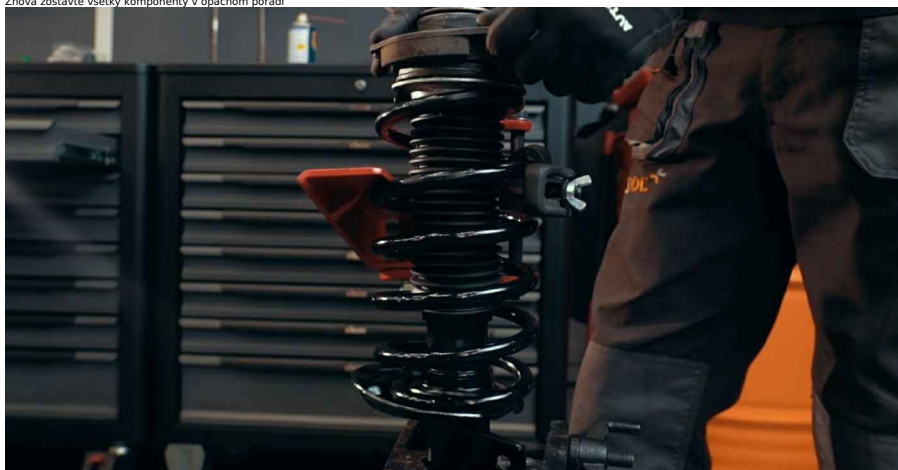
Dôležitá! • Dbajte na správnu pozíciu uloženia vzpery, aby sa zaručilo, že bude natočená do správneho smeru
