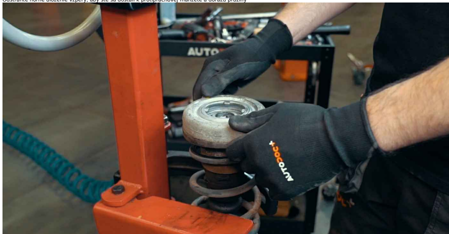
Pozor! • Doraz pružiny môže byť inštalovaný na plesnej tyči alebo pripevnený k uloženiu • Protiprachová manžeta môže byť pripevnená k dorazu pružiny, inštalovaná medzi pružinou a uložením, alebo zaistená k uloženiu
