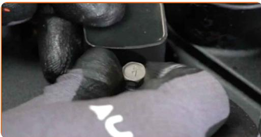
**14** Utiahnite upevňovacie prvky cievky zapalovania. Použite nástavec č.10. Použite momentový kľúč. Utiahnite ju krútiacim momentom 9 Nm.
