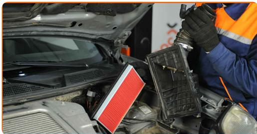
**6** Odpojte hadičku ventilácie kľukovej skrine od vzduchového potrubia.
