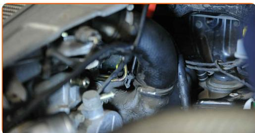
**25** Zaskrutkujte fixačné skrutky na svorku palivového filtra. Použite nástavec č.10. Použite ráčňový kľúč. Použite krížový skrutkovač PH.
