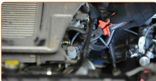
**13** Odpojte rúrky od palivového filtra.
