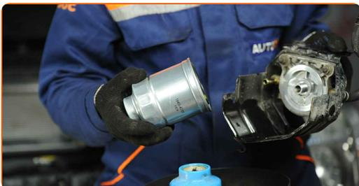
**17** Vyčistite uloženie a kryt palivového filtra. Použite viacúčelový čistiaci sprej.
