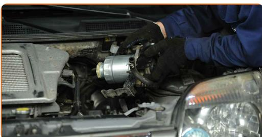
**23** Zapojte rúrky do palivového filtra. Použite kliešte.
