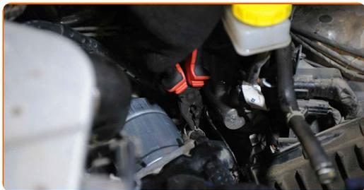
**24** Utiahnite upevňovacie svorky rúrok palivového filtra. Použite kliešte.
