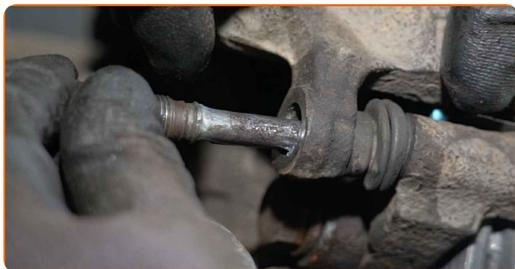
**21** Uťahnite upevňovacie prvky brzdového strmeňa. Použite nástavec č.14. Použite momentový kľúč. Uťahnite ju krútiacim momentom 32 Nm.
