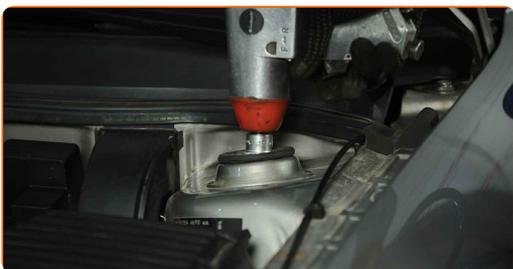
**38** Natrite vrchné upevnenie uloženia tlmiča. Použite medené mazivo.
