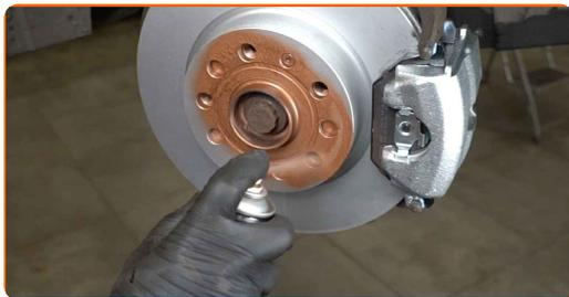
**20** Vyčistite povrch brzdového kotúča. Použite čistič bŕzd.
