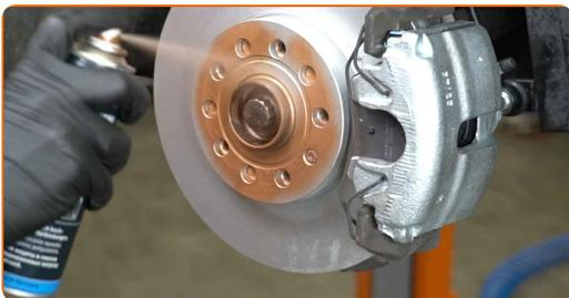
**22** Vyčistite povrch brzdového kotúča. Použite čistič brzd.
