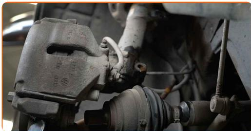
**26** Uvoľnite spodný upevňovací prvok spájajúci vzperu tlmiča a hlavu ložiska čapu kolesa. Použite špeciálny nástavec na odstránenie tlmiča. Použite ráčňový kľúč.
