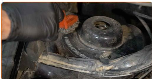
**6** Uvoľnite vrchný upevňovací prvok ložiska vzpery tlmiča. Použite nástavec č.13. Použite ráčňový kľúč.
