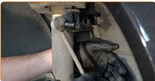
**15** Odpojte vodiče a brzdovú hadičku od svorky na vzpere tlmiča. Použite páčidlo.
