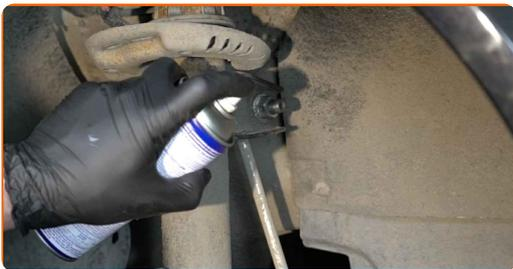
**13** Odskrutkujte upevnenie spájajúce vzperu stabilizátora k vzpere tlmiča. Použite nástavec č.18. Použite ráčňový kľúč.
