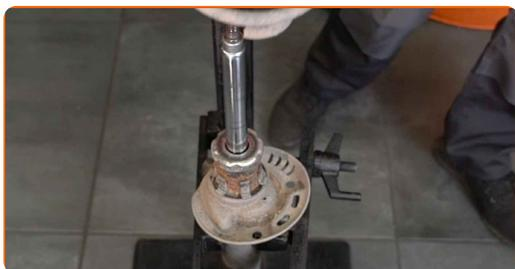
**38** Odstráňte starý tlmič z hydraulického kompresora na vinuté pružiny.
