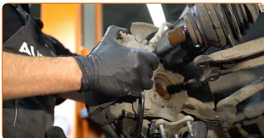
**29** Odskrutkujte upevňovacie prvky na vrchnej strane uloženia vzpery tlmiča.
