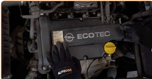
**3** Odpojte konektor z cievky zapáľovania. Použite plochý skrutkovač.
