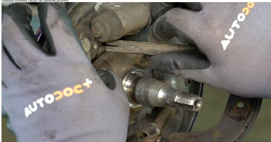
18 Odstráňte pravú brzdovú čelust'.
