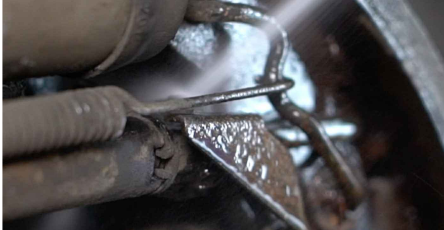
13 Uvoľnite nastavovací prvok brzdovej čeluste. Použite páčidlo.
