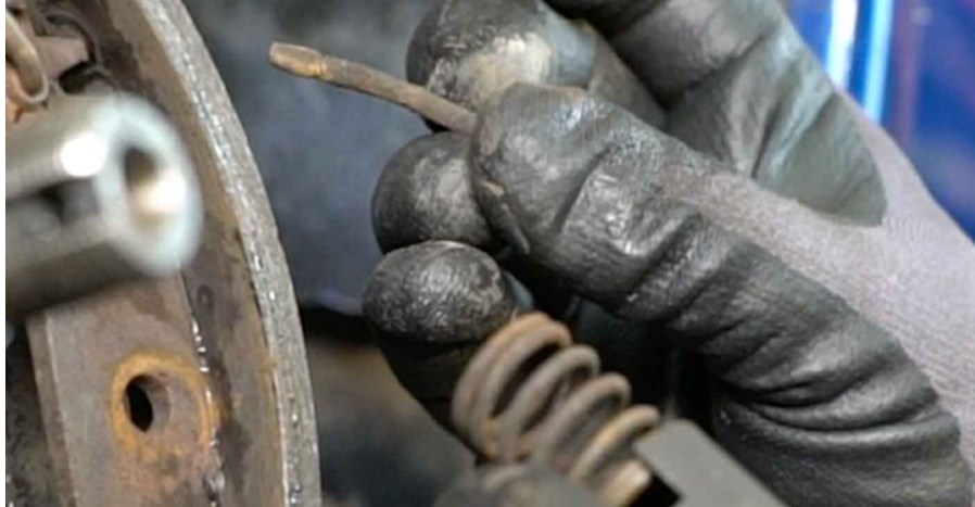
17 Odpojte brzdovú čelust' od spodnej pružiny.
