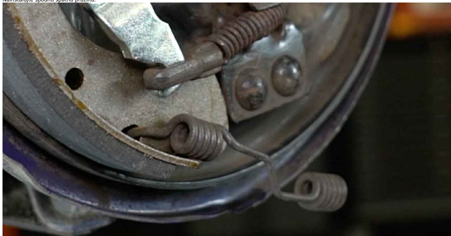
26 Odstráňte hornú pružinu a nastavovač.
