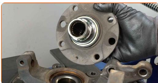
**43** Vyčistite zádržný krúžok ložiska náboja kola.
