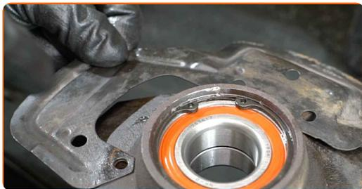
**55** Utiahnite upevňovacie prvky opornej dosky brzdového kotúča. Použite krížový skrutkovač PH. Použite momentový kľúč. Utiahnite ju krútiacim momentom 7 Nm.
