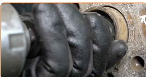
**16** Odstráňte podložku ložiska kolesa. Použite páčidlo.
