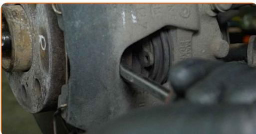
**18** Vyčistite upevňovacie prvky držiaka brzdového strmeňa. Použite drôtenú kefu. Použite sprej WD-40.
