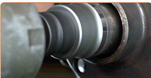
**73** Vyčistite náboj. Použite drôtenú kefu. Natrite kontaktný povrch. Použite keramické mazivo.
