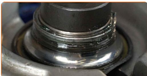
**50** Vyčistite montážny otvor ložiska náboja. Použite drôtenú kefu. Použite sprej WD-40. Použite viacúčelový čistiaci sprej.
