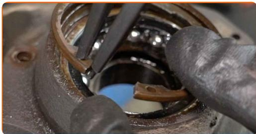
**48** Vytlačte ložisko náboja kola. Použite sadu vložky a orechu ložiska.
