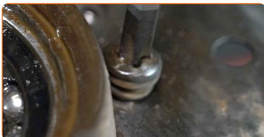
**46** Odstráňte kryt brzdového kotúča.
