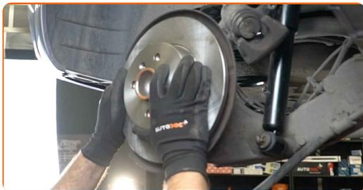
**40** Upevnite upevnenie brzdového kotúča. Použite hviezdicový Torx T30. Použite momentový kľúč. Uťahnite ju krútiacim momentom 8 Nm.
