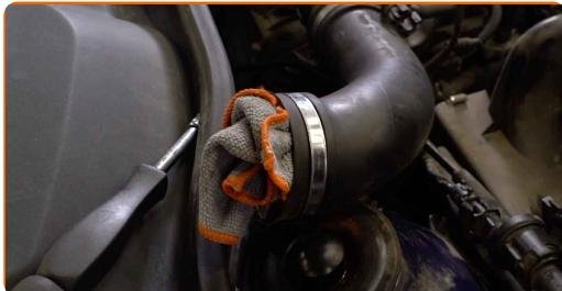
**6** Odpojte upevnenia spájajúce vzduchové potrubie a káblový zväzok ku krytu vzduchového filtra.
