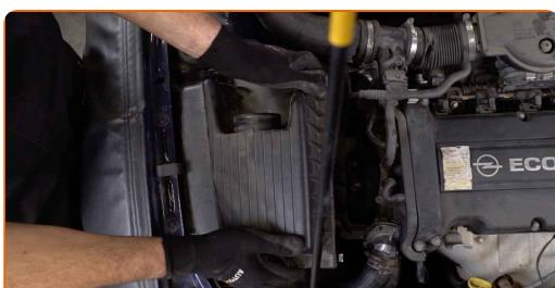
**8** Odskrutkujte upevňovacie skrutky uloženia filtra. Použite hviezdicový Torx T30. Použite ráčňový kľúč.
