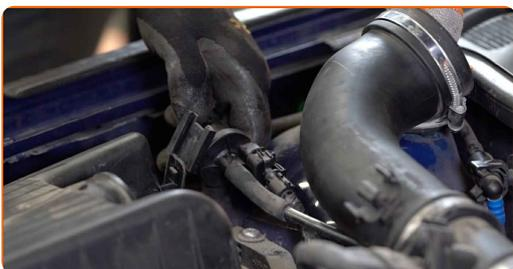
**7** Odstráňte veko filtra. Odstráňte filtračný prvok z krytu filtra.
