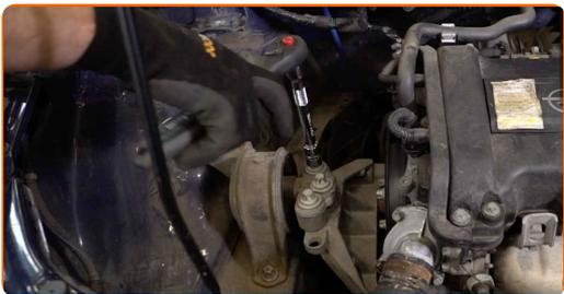
**17** Odstráňte upevnenie motora.
