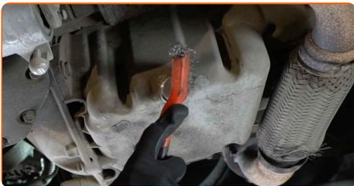
**7** Odskrutkujte výpust. Použite hviezdicový Torx T40. Použite ráčňový kľúč.
