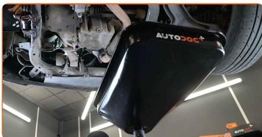
**6** Vyčistite miesto výpustného otvoru olejovej vane. Použite drôtenú kefu. Použite viacúčelový čistiaci sprej.
