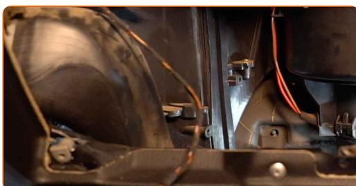
**12** Pripojte upevnenia spájajúce vzduchové potrubie a káblový zväzok ku krytu vzduchového filtra.
