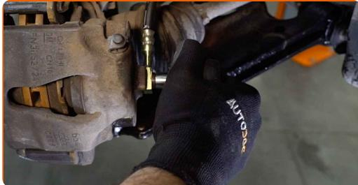
**16** Vyčistite montážnu pozíciu brzdovej hadičky na rúrke brzdového okruhu. Použite čistič bŕzd.
