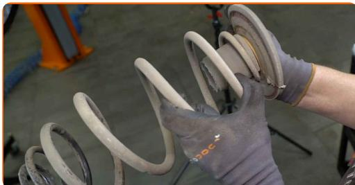
Výmena: pružin podvozku – OPEL Astra H Hatchback (A04). Tip od AUTODOC:
