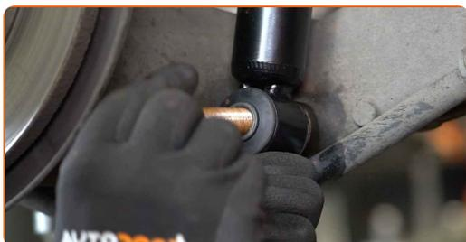
**18** Zaskrutkujte spodné upevnenie tlmiča. Použite nástavec č.E20. Použite ráčňový kľúč.
