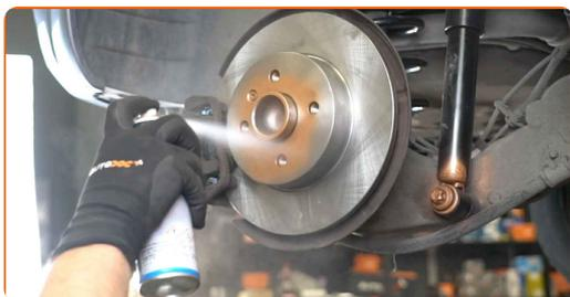
**25** Vyčistite povrch brzdového kotúča. Použite čistič brzd.
