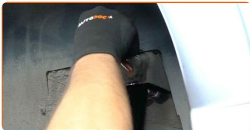
**16** Zaskrutkujte vrchný upevňovací prvok tlmiča. Použite nástavec č.E18. Použite ráčňový kľúč.
