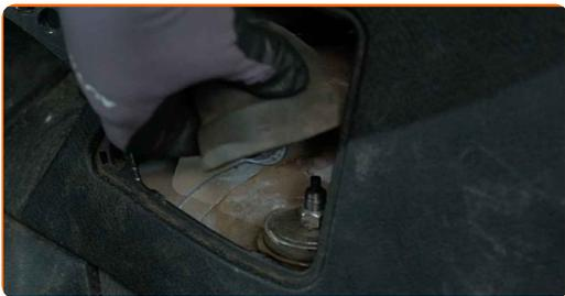
**6** Vyčistite upevňovacie prvky tlmiča. Použite drôtenú kefu. Použite sprej WD-40.
