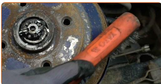
**32** Natrite povrch, kde je brzdový kotúč v kontakte s ráfikom kolesa. Použite keramické mazivo.
