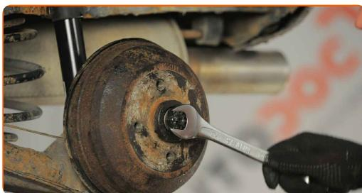
**24** Nainštalujte závlačku upevňovacej matice ložiska náboja. Použite okrúhle kliešte.
