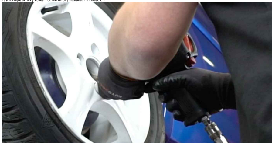
AUTODOC odporúča: • Upozornenie! Pre vyhnutie sa zraneniu držte koleso pri zaskrutkovaní upevňovacích skrutiek na auto. OPEL Corsa C Van (X01)
