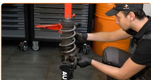
Výmena: jednotka pruženia, tlmič pruženia – OPEL Corsa D Van (S07).
