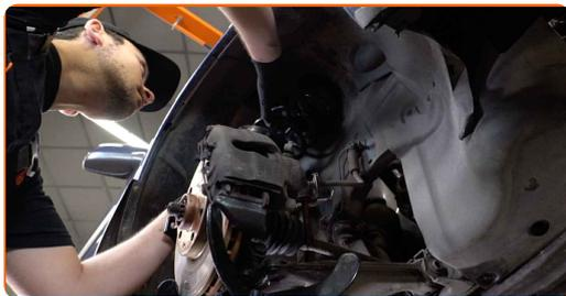
33 Utiahnite vrchnú upevňovaciu maticu vzpery tlmiča. Neuťahujte ho.
