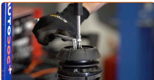
Výmena: jednotka pruženia, tlmič pruženia – OPEL Corsa C Van (X01). Tip od AUTODOC:
