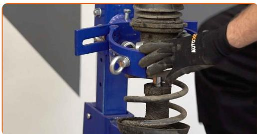
Výmena: jednotka pruženia, tmič pruženia – OPEL Corsa C Van (X01).
