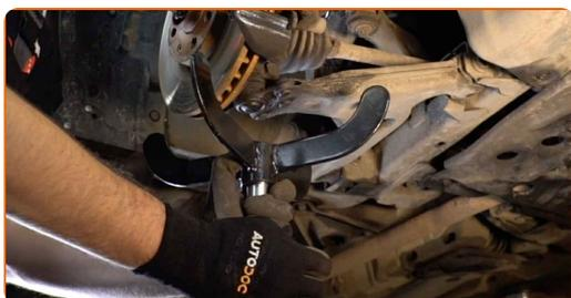
Výmena: jednotka pruženia, tmič pruženia – OPEL Corsa C Van (X01). Tip:
