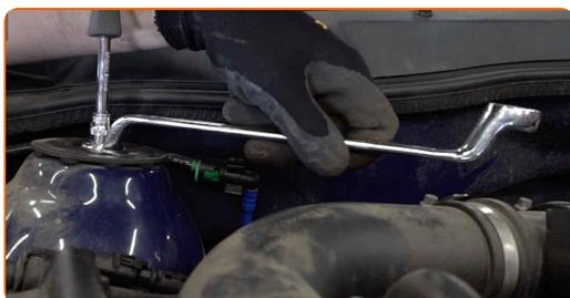
Výmena: jednotka pruženia, tlmič pruženia – OPEL Corsa C Van (X01).
