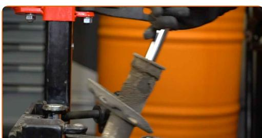
Výmena: jednotka pruženia, tlmič pruženia – OPEL Corsa Utility Pick-up.
