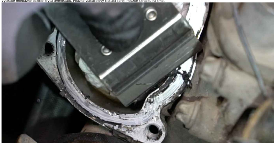
25 Nainštalujte nový kryt termostatu spolu s termostatom.
