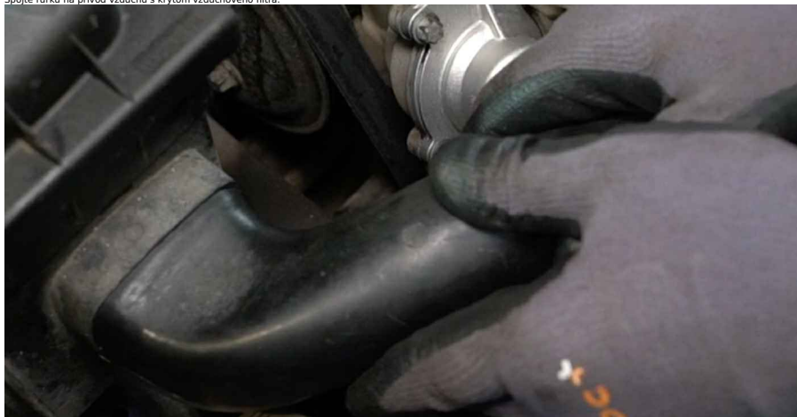
32 Pripevnite sponu na nasávaciu hadičku vzduchového filtra.
