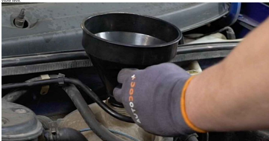
35 Chladiacu kvapalinu nalejte do nádrčky na chladiacu kvapalinu.
