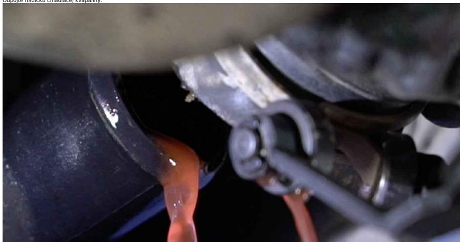
8 Odpojte hadičku chladiacej kvapaliny.
