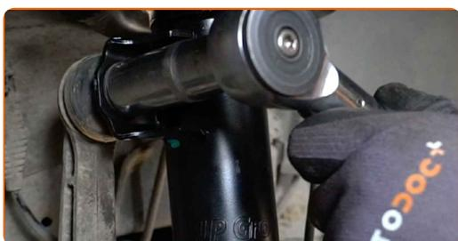
**53** Natrite upevnenia ložiska vzpery tlmiča. Natrite upevňovacie prvky hlavy ložiska čapu kola. Použite medené mazivo.
