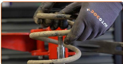
**31** Odstráňte starý tlmič z hydraulického kompresora na vinuté pružiny.
