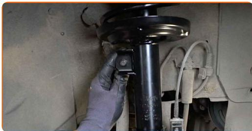
**52** Utiahnite upevnenie spájajúce vzperu stabilizátora k vzpere tlmiča. Použite kombinačný kľúč č.17. Použite nástavec č.18. Použite momentový kľúč. Utiahnite ju krútiacim momentom 55 Nm.
