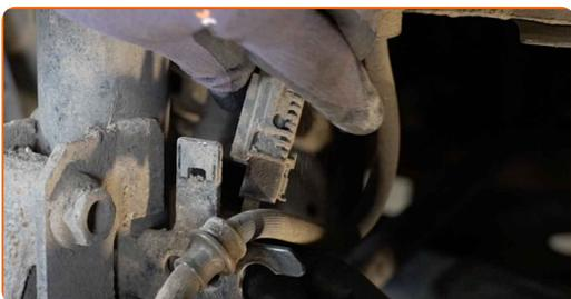
**15** Vyčistite upevňovacie prvky spájajúce vzperu tlmiča a hlavu ložiska čapu kola. Použite drôtenú kefu. Použite sprej WD-40.
