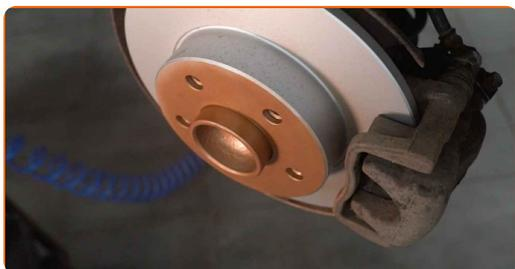
**23** Vyčistite povrch brzdového kotúča. Použite čistič brzd.
