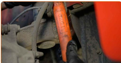
**25** Odskrutkujte upevňovaciu svorku brzdovej hadičky od vzpery tlmiča. Použite nástavec č.14. Použite ráčňový kľúč.
