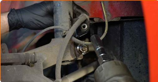
**26** Odpojte vodiče snímača ABS.
