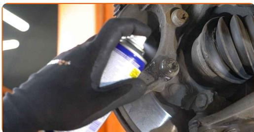
13 Odskrutkujte upevnenie svorky brzdového strmeňa. Použite hviezdicový Torx T55. Použite vratidlo. Použite ráčňový kľúč.
