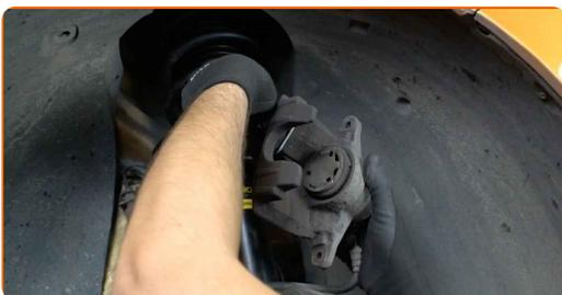
Výmena: brzdových kotúčov – PEUGEOT 206 Hatchback (2A/C). Tip od odborníkov z AUTODOC:
