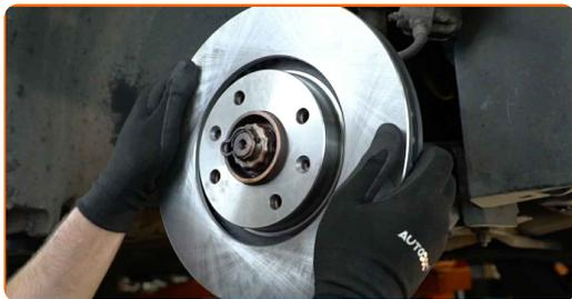
20 Upevnite upevnenie brzdového kotúča. Použite hviezdicový Torx T30. Použite momentový kľúč. Uťahnite ju krútiacim momentom 9 Nm.
