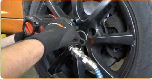
**34** Dajte auto dolu a skrutkujte skrutky v krížovom poradí. Použite rázový nástavec na koleso č. 17. Použite momentový kľúč. Utiahnite ju krútiacim momentom 100 Nm.
