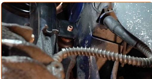
**65** Utiahnite upevnenie spájajúce vzperu stabilizátora k vzpere tlmiča. Použite nástavec č.16. Použite momentový klíč. Utiahnite ju krútiacim momentom 35 Nm.
