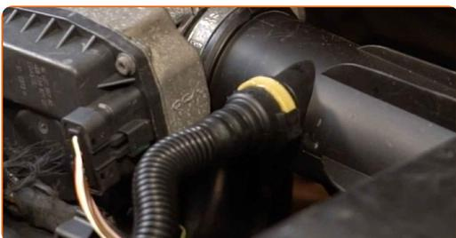
**19** Upevnite svorku na vzduchovej prívodnej hadičke. Použite nástavec č.7. Použite ráčňový kľúč.
