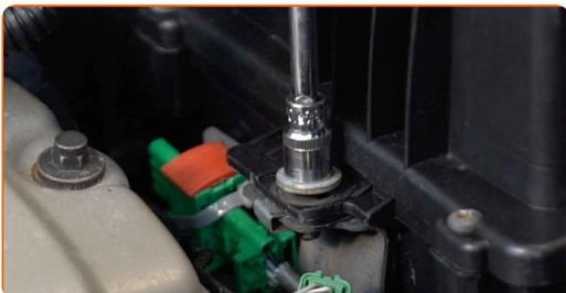
**18** Spojte hadičku ventilácie kľukovej skrine so vzduchovým potrubím.
