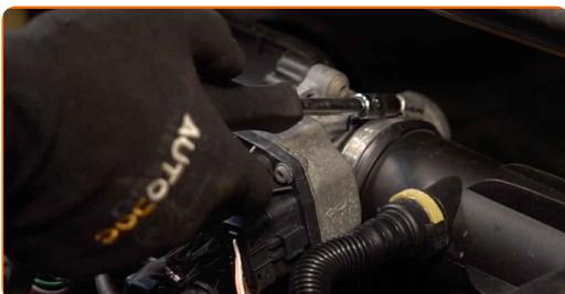
**4** Odpojte hadičku ventilácie kľukovej skrine od vzduchového potrubia.
