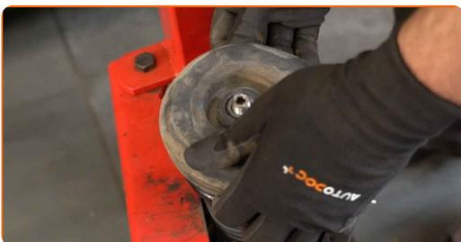
48 Upevnite maticu piestu vzpery tlmiča. Použite nástavec č.19. Použite imbusový kľúč č. H6. Použite momentový kľúč. Utiahnite ju krútiacim momentom 75 Nm.
