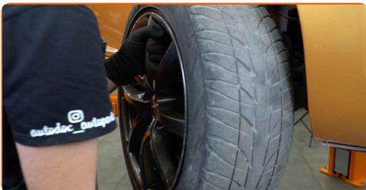
**12** Vyčistite upevňovacie prvky vzpery stabilizátora. Použite drôtenú kefu. Použite sprej WD-40.
