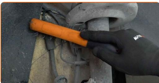
**13** Odskrutkujte upevnenie spájajúce vzperu stabilizátora k vzpere tlmiča. Použite kombinačný kľúč č.16. Použite hviezdicový Torx T30. Použite ráčňový kľúč.
