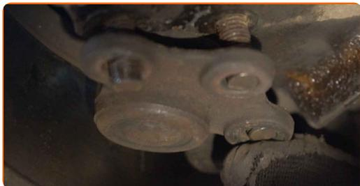
**63** Zaskrutkujte upevňovacie prvky guľového čapu. Použite kombinačný kľúč č.17. Použite nástavec č.16. Použite ráčňový kľúč.
