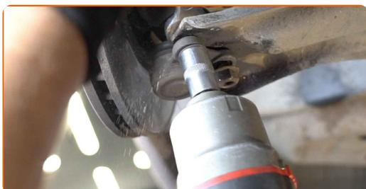
**64** Utiahnite upevňovacie prvky spájajúce guľový čap k ovládacímu ramenu. Použite nástavec č.16. Použite momentový kľúč. Utiahnite ju krútiacim momentom 65 Nm.
