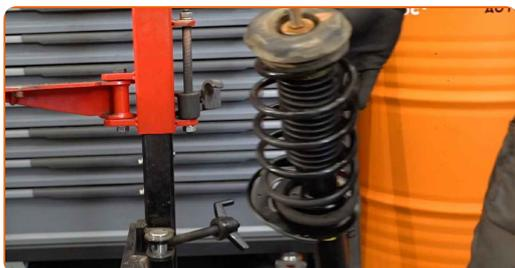
52 Natrite montážne pozície tlmiča pruženia. Použite drôtenú kefu. Použite sprej WD-40.
