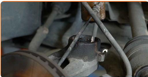
**32** Odskrutkujte upevňovacie prvky na vrchnej strane uloženia vzpery tlmiča.
