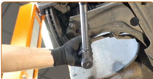
**65** Utiahnite spodné upevňovacie prvky spájajúce vzperu tlmiča k hlave ložiska čapu. Použite nástavec č.16. Použite momentový kľúč. Utiahnite ju krútiacim momentom 55 Nm.
