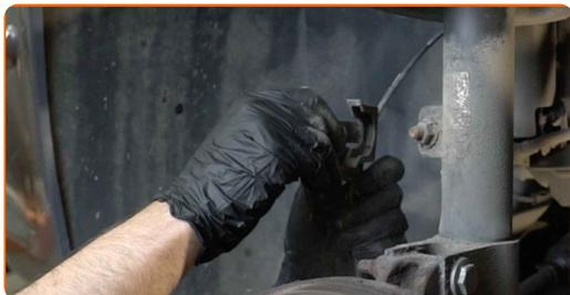
**21** Vyčistite upevňovacie prvky vzpery stabilizátora. Použite drôtenú kefu. Použite sprej WD-40.
