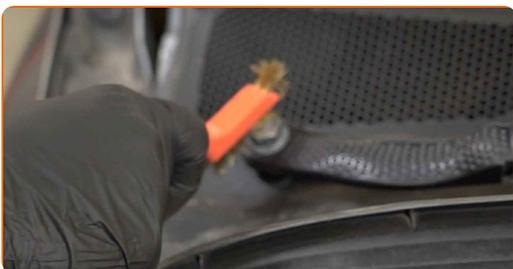
**4** Odskrutkujte upevňovacie prvky ramien stieračov. Použite nástavec č.16. Použite ráčňový kľúč.
