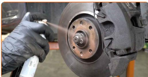
**67** Vyčistite povrch brzdového kotúča. Použite čistič brzd.
