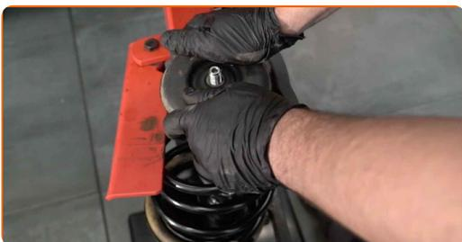
46 Upevnite maticu piestu vzpery tlmiča. Použite nástavec č.18. Použite imbusový kľúč č. H7. Použite momentový kľúč. Utiahnite ju krútiacim momentom 69 Nm.
