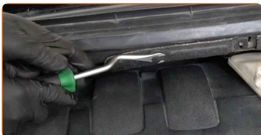
**8** Odskrutkujte upevňovacie prvky plastového krytu pod stierače. Použite nástavec č.10. Použite ráčňový kľúč.
