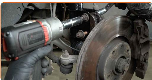
**58** Vyčistite montážne pozície vzpery stabilizátora. Použite drôtenú kefu. Použite sprej WD-40.
