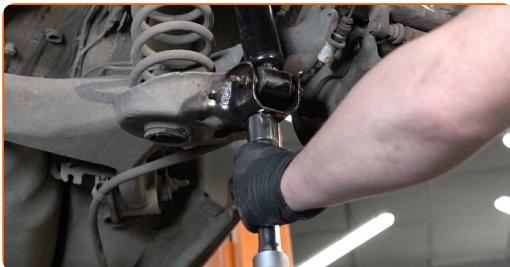
8 Odskrutkujte spodné upevnenie tlmiča. Použite kombinačný kľúč č.13. Použite nástavec č.15. Použite ráčňový kľúč.
