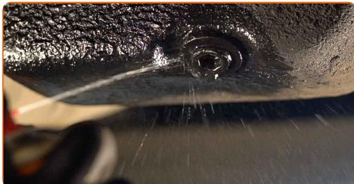
**7** Pod výpustný otvor položte nádobu na vytekajúci olej s objemom aspoň 5 l.
