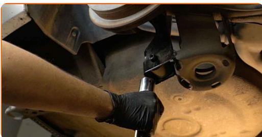
**10** Odstráňte upevňovaciu skrutku. Použite kombinačný kľúč č.16. Použite nástavec č.16. Použite ráčňový kľúč.
