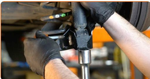
**11** Odstráňte upevnenie spod nosníka zadnej nápravy.
