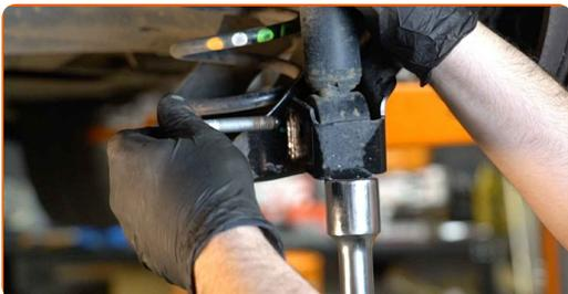
**15** Odstráňte upevnenie spod nosníka zadnej nápravy.
