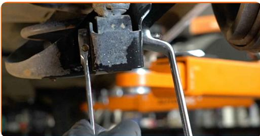
**9** Podprite nosník zadného odpruženia kolies. Použite zdvihák s hydraulickými prevodmi.
