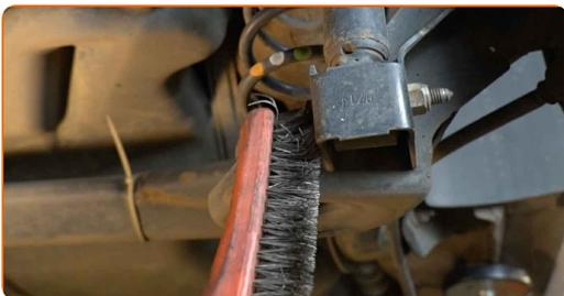
**8** Odskrutkujte spodné upevnenie tmiča. Použite kombinačný kľúč č.16. Použite nástavec č.16. Použite vratidlo.
