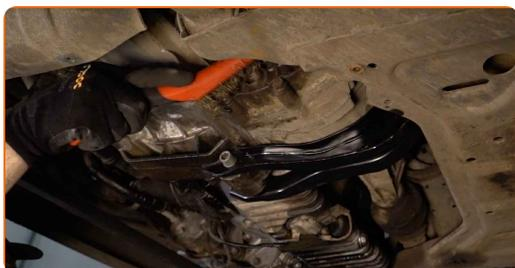
**7** Pod výpustný otvor položte nádobu na vytekajúci olej s objemom aspoň 3 l.
