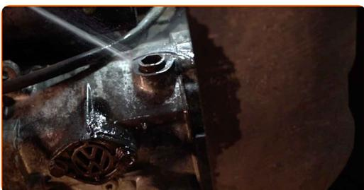
**16** Znovu namontujte spodný kryt olejovej vane.
