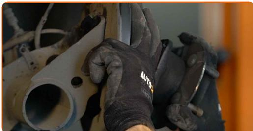
**13** Vyčistite montážny otvor ložiska náboja. Použite drôtenú kefu.
