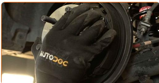
**15** Utiahnite upevňovací prvok ložiska náboja kolesa. Použite nástavec č.10. Použite momentový kľúč. Utiahnite ju krútiacim momentom 61 Nm.
