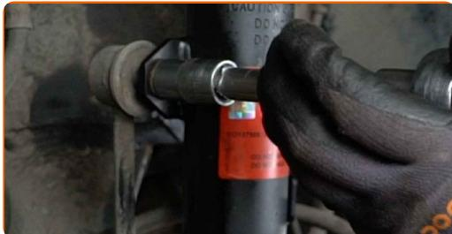
**59** Utiahnite spodné upevňovacie prvky spájajúce vzperu tlmiča k hlave ložiska čapu. Použite kombinačný kľúč č.19. Použite nástavec č.19. Použite momentový kľúč. Utiahnite ju krútiacim momentom 143 Nm.
