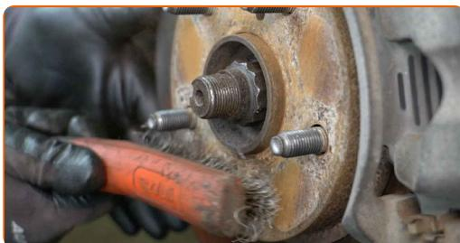
**65** Natrite povrch, kde je brzdový kotúč v kontakte s ráfikom kolesa. Použite keramické mazivo.
