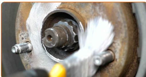
**66** Vyčistite povrch brzdového kotúča. Použite čistič bŕzd.
