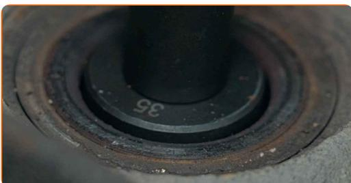
**31** Vyčistite zádržný krúžok ložiska náboja kolesa. Použite drôtenú kefu. Použite sprej WD-40.
