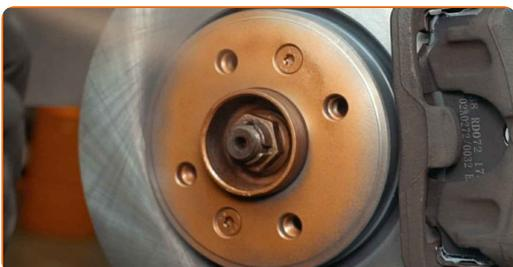
**71** Vyčistite povrch brzdového kotúča. Použite čistič brzd.
