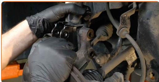
27 Odskrutkujte upevňovacie prvky na vrchnej strane uloženia vzpery tlmiča.
