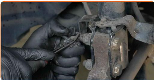
**19** Vyčistite upevňovací prvok svorky, ktorá spája brzdovú hadičku k tmiču. Použite drôtenú kefu. Použite sprej WD-40.
