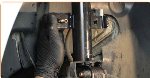
**59** Utiahnite upevnenie spájajúce vzperu stabilizátora k vzpere tlmiča. Použite nástavec č.16. Použite momentový kľúč. Utiahnite ju krútiacim momentom 44 Nm.
