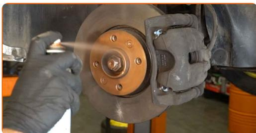
**63** Vyčistite povrch brzdového kotúča. Použite čistič brzd.
