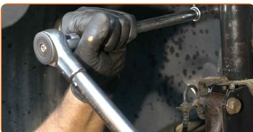
**60** Utiahnite spodné upevňovacie prvky spájajúce vzperu tlmiča k hlave ložiska čapu. Použite kombinačný kľúč č.18. Použite nástavec č.18. Použite momentový kľúč. Utiahnite ju krútiacim momentom 105 Nm.
