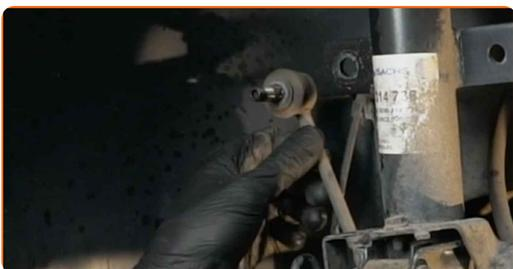
**18** Odpojte vodiče snímača ABS. Použite páčidlo.
