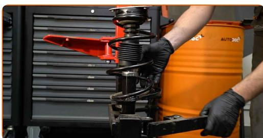
47 Natrite montážne pozície tlmiča pruženia. Použite drôtenú kefu. Použite sprej WD-40.
