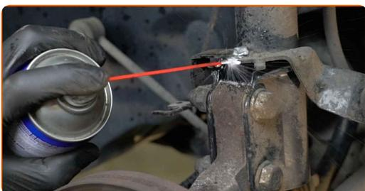
**20** Odskrutkujte upevňovaciú svorku brzdovej hadičky od vzpery tmiča. Použite nástavec č.10. Použite ráčňový kľúč.
