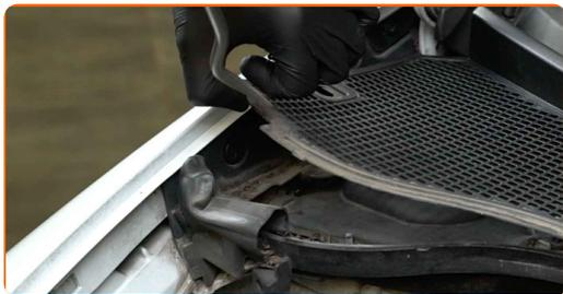
**6** Odskrutkujte upevňovacie prvky krytu uloženia tlmiča. Použite nástavec č.10. Použite ráčňový kľúč.
