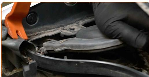
**8** Vyčistite upevňovacie prvky vrchného ložiska vzpery tlmiča. Použite drôtenú kefu. Použite sprej WD-40.
